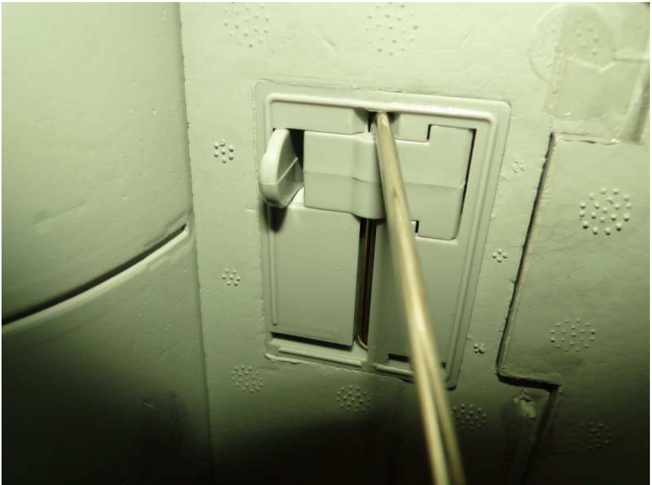
Fahrwerk einklipsen – fertig!
