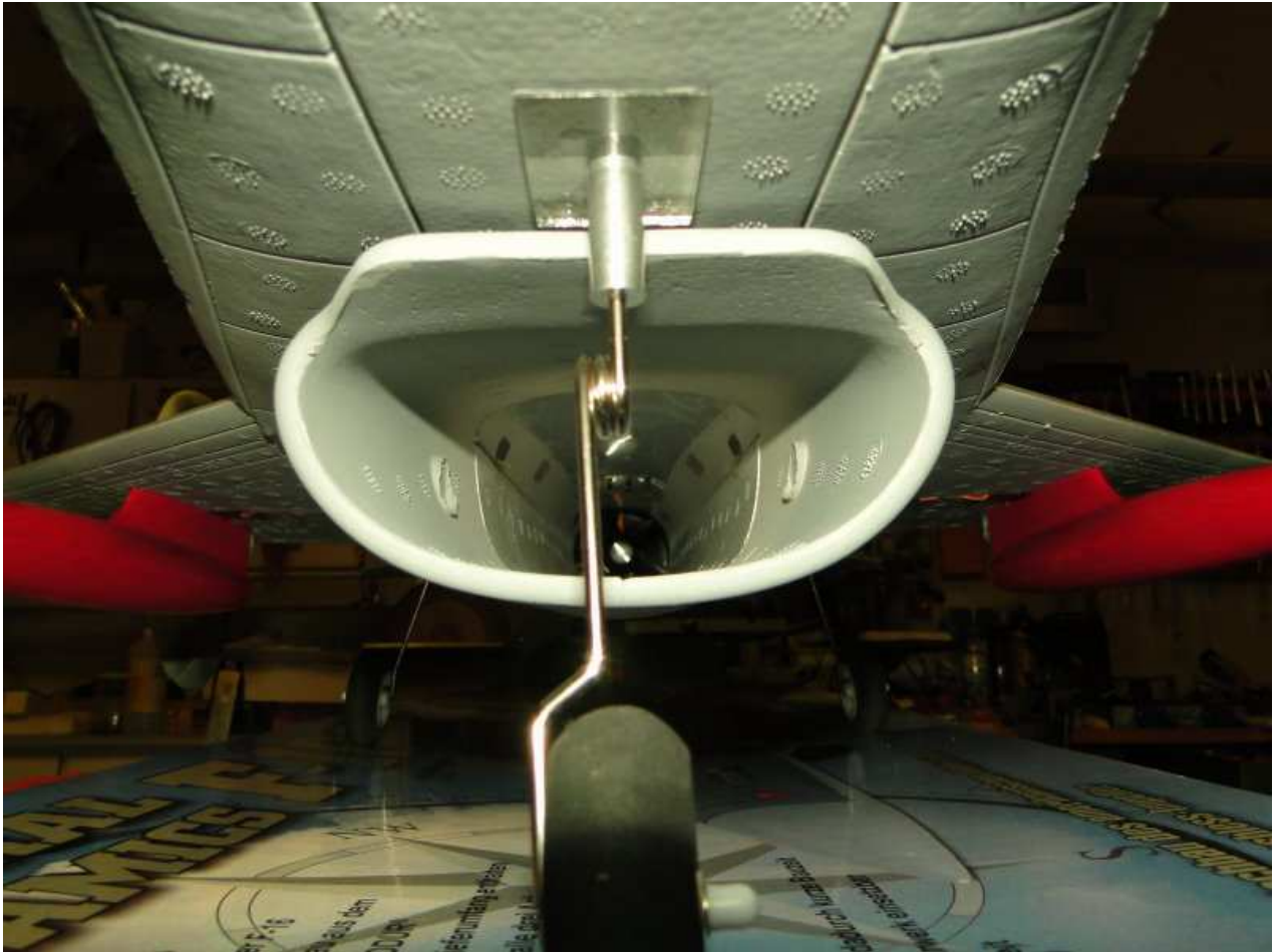
Lufteinlass. Der Halbrunde Teil gehört bei Flügen ohne Fahrwerk verstärkt. Auch gut zu sehen die Befestigung des Bugfahrwerks. ACHTUNG: Ausschläge verringern, sonst biegt die Fuhre flugs ab!
